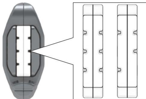
Il NUOVO Defender® MAGNETICO DF371 (*Brevettato*) regolabile a molla, è composto da un Defender® d'acciaio con mostrina in lamiera (72 x 90 mm) e da una speciale copertura rotante che protegge completamente l'entrata chiave. La rotazione del corpo rotante è comandata dalla speciale chiave magnetica, la cui sicurezza è data dalla combinazione delle polarità dei 5 magneti e 8 posizioni possibili.
