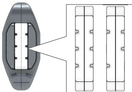
Il Defender® DF43 (*Brevettato*) è composto da un Defender® e da una mostrina in acciaio ad alta resistenza (HRC 53) (65 x 90 mm) e da una speciale copertura rotante che protegge completamente l'entrata chiave. La rotazione del corpo rotante è comandata dalla speciale chiave magnetica, la cui sicurezza è data dalla combinazione delle polarità di 7 magneti in 8 posizioni possibili.
